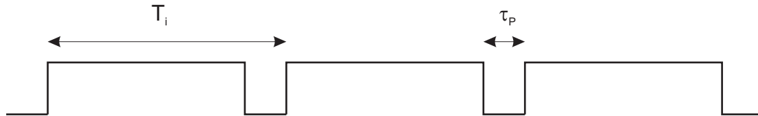
FIGURE 6 – Fonction créneau produite par le générateur d'impulsions.
